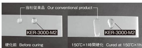
弊社従来品とKER-3000-M2の比較(傾き60度で保ち、150°Cで硬化)
