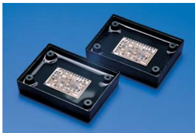
電子部品をシリコンゲルでポッティングした一例
