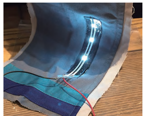
布上の導電性シリコーンゴム回路でLEDが点灯
