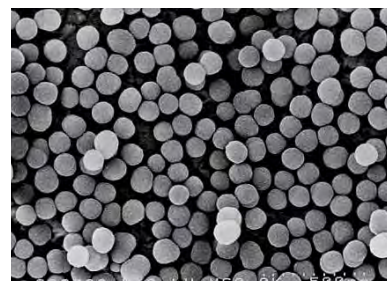
シリカパウダー-X-24-9163Aの電子顕微鏡写真
