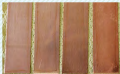
未処理 KBM-403 エポキシシラン 処理 ベンゾ トリアゾール 処理 X-12-1214A 処理
