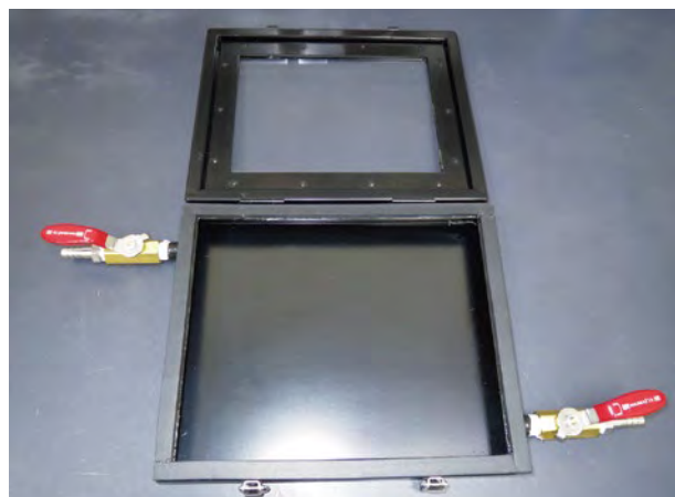
当社簡易窒素置換設備
