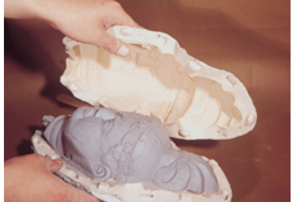
積層法による彫像の型取り
