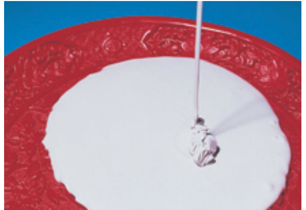
微細な凹部まで流入するシリコンRTVゴム
