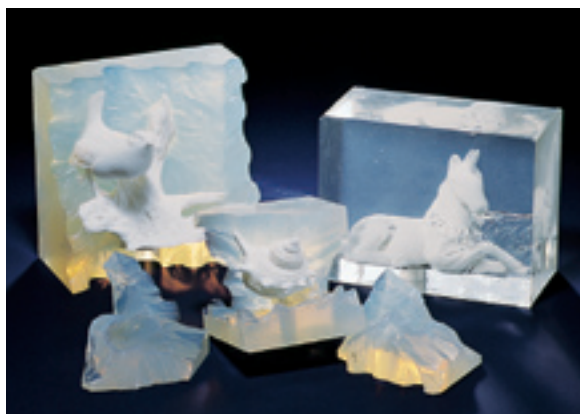
透明、半透明のシリコンRTVゴムによる型取り
