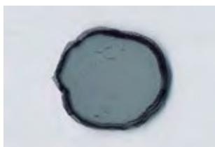
オープン 70°C×1時間加熱後 ヒートサイクル試験 25サイクル Oven-heated to 70°C for 1 h + 25 cycles
