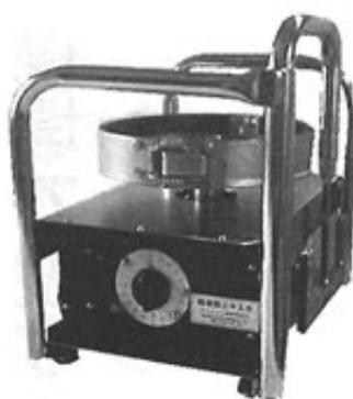
写真1 回転式自動練り混ぜ機
