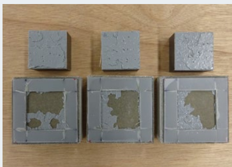
イヌバシールの破断状況
