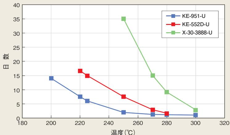
り、250℃～300℃の高温領域でも優れたゴム特性を発揮する。耐熱性の指標として、各材料の初期切断時伸びを100とした時に、70となった時の時間を温度毎にプロットして図2に示す。図2の中でプロットされる点が上側にあるほど、該当温度での切断時伸びが変化しにくく、常態値に近い状態での使用が可能と考えられる。250℃の場合、KE-951-U (汎用品)は切断時伸びが3割低下するのが2日であるのに対し、KE-552D-Uは同条件で7日、新規に開発したX-30-3888-Uは同条件で35日と大幅に伸びている。220℃付近ではKE-552D-UとX-30-3888-Uとでは耐熱
