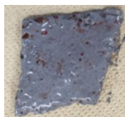
一般的なシリコン放熱シートを 150℃のATFに500h浸漬させた後の外観
