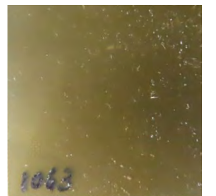
外観:ハンダ耐熱試験後 未処理 処理
