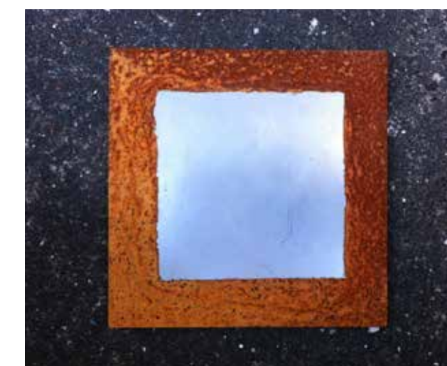
シート貼り付け部錆なし
