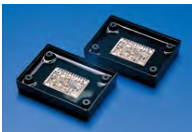
電子部品をシリコンゲルでポッティングした一例
