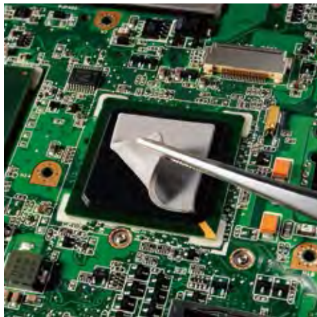
写真1 低硬度放熱シリコンゴムシート 「TC-CAシリーズ」
