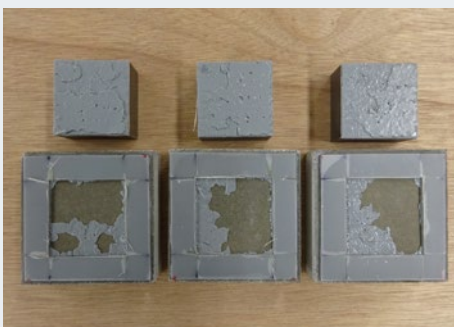
イヌバシールの破断状況
