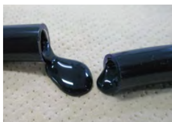
ポットイング後30分経過 性状:液状
